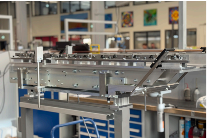
Beispielanwendung: SLL 800-1200 als Staustrecke
