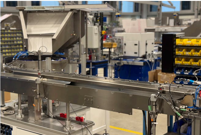
Beispielanwendung: SLL 804 Z-1600 als Stau- und Zubringstrecke im Pharmabereich
